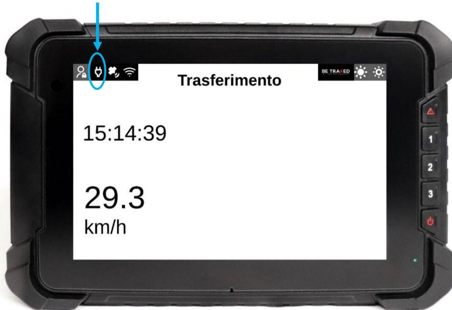
Figura 1 - Spia alimentazione di colore bianco: dispositivo alimentato correttamente
