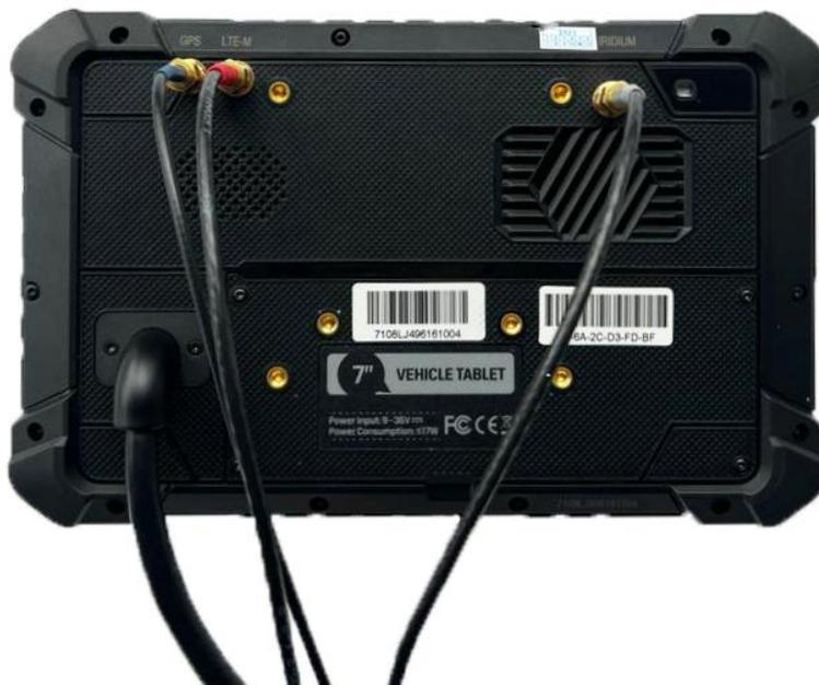
Figura 3 - Connettori antenne
